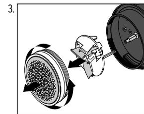
Drehen Sie den Scherkopf gegen den Uhrzeigersinn ab.
