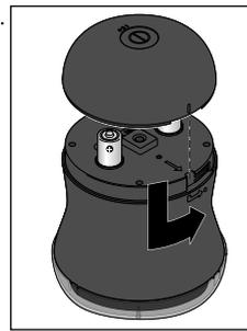
Setzen Sie den Batteriefachdeckel wieder auf. Die Rastnase im Deckel muss dabei in die mit dem Pfeil markierte Aussparung am Gerät greifen. Drehen Sie den Deckel dann gegen den Uhrzeigersinn fest.
